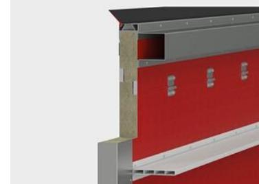
Дээд ба доод хавтангийн дотор болон гадна талд сууринуулсан ган оруулга, профиль нь шаардлагатай хатуу байдлыг ханггадаг. Хөнгөн цагааны профилийн нэмэлтийг хаалганы дээд самбар дээр сууринуулсан. ТАЙЛБАР: 4500 мм-ээс дээш өргөнтэй хаалганууд дээр хийгдэх.
