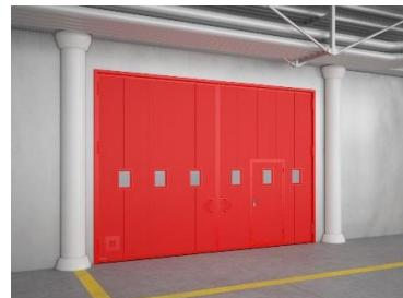
Нэмэлт жижиг хаалганы хэмжээ нь 900 × 2050 мм байна. Хаалганы хавтасны галд тэсвэртэй цонх (400x300 мм хэмжээтэй) Галын таг (200x200 мм хэмжээтэй) хаалгыг онгойлгох шаардлагагүйгээр галыг унтраахад ашиглагддаг.
